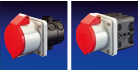
Zwischenflansch zum Aufbau von Steckdosen, Flanschmaß 75x75 mm, Bohrlochabstand 60x60 mm, für Unterputz- und Kabelkanaldosen
