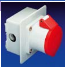
Unterputzdose und Montageflansch für Anbausteckdosen Flanschmaß 75x75 mm Bohrlochabstand 60x60 mm
