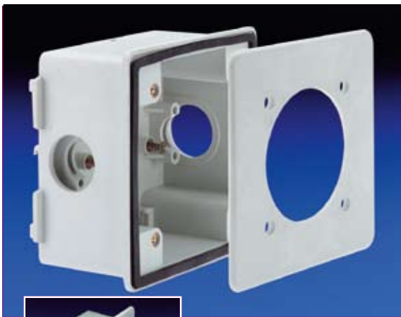
Unterputzdose und Montageflansch für Anbausteckdosen Flanschmaß 75x75 mm Bohrlochabstand 60x60 mm
